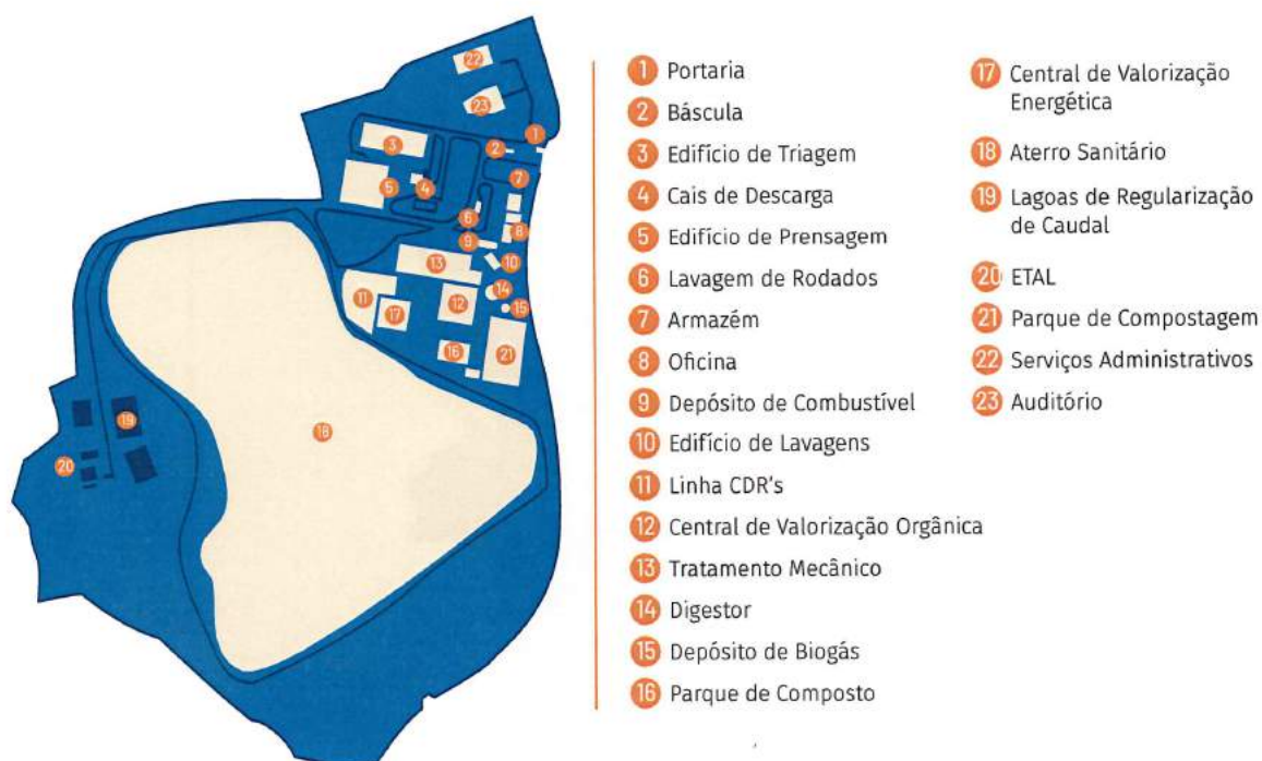
Figura 5 • Esquema do CTRSU de Tondela.
